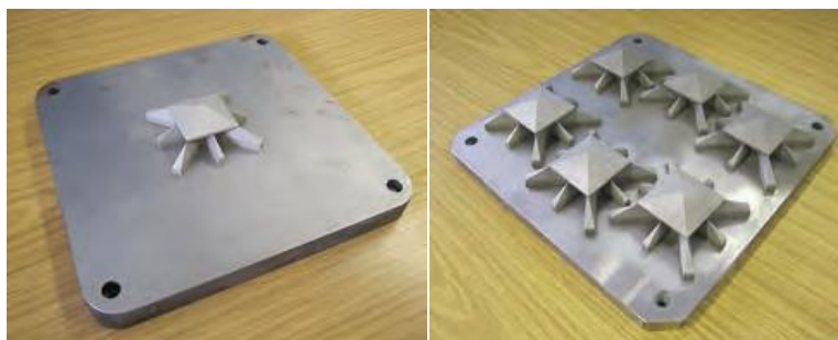
Obr. 2 Rychlost výroby versus počet součástí – vlevo jedna součást na pracovní ploše, vpravo pracovní plocha zaplněna na maximum [18]
